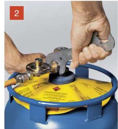
Pas à gauche: pour dévisser, tourner dans le sens des aiguilles d'une montre!
