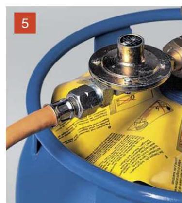
Le tuyau doit être bien enfoncé jusqu'à
