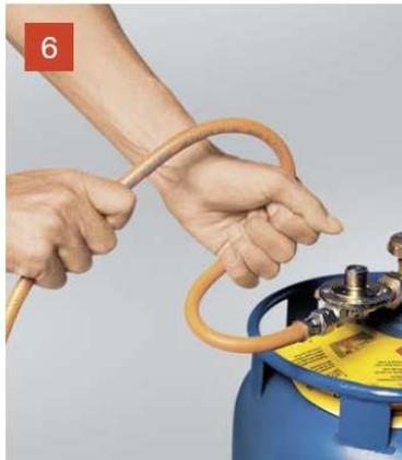
Changer immédiatement les tuyaux endommagés, cassants ou craquelés. Contrôler l'étanchéité avec de l'eau savonneuse ou un produit moussant, jamais avec une flamme!
